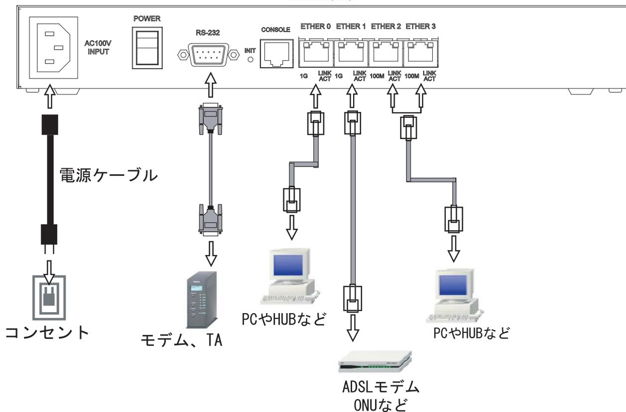
1 XR-730 と xDSL/ ケーブルモデムやパソコン・HUB など、接続する全ての機器の電源が OFF になっていることを確認してください。
