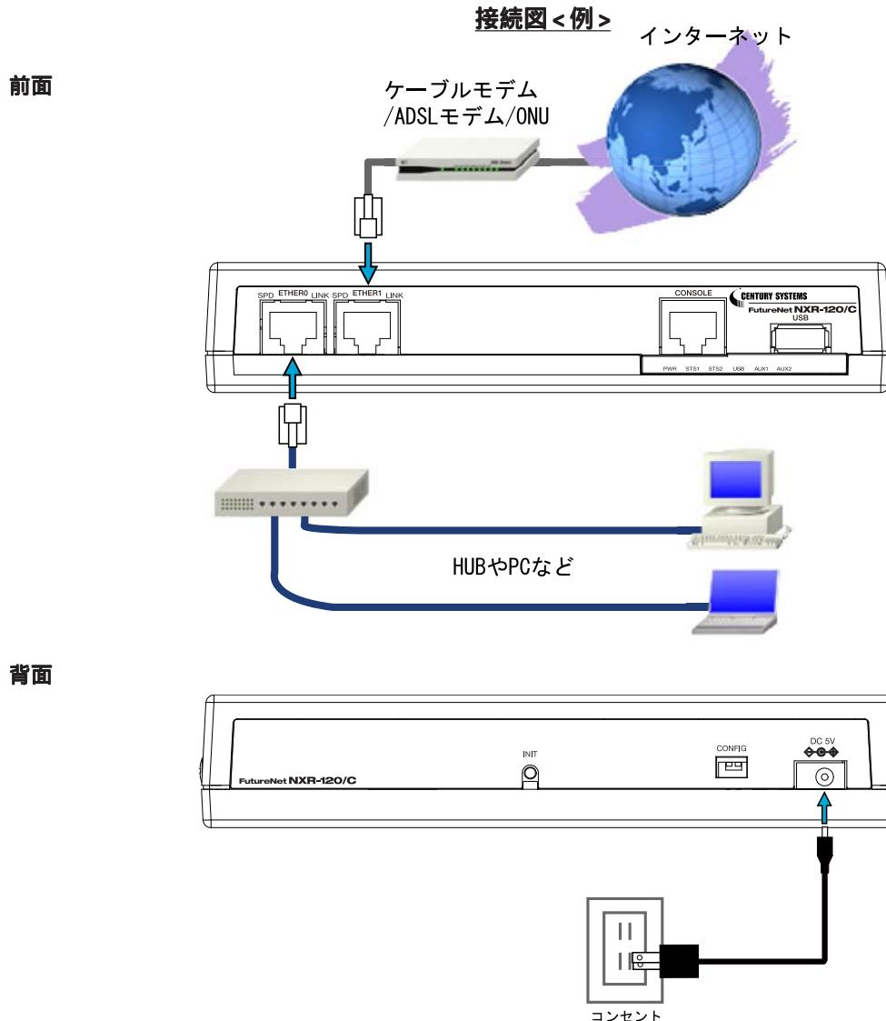
1 本装置とxDSL MODEM/ケーブル MODEM/ONU や PC・HUB など、接続する全ての機器の電源が“OFF”になっていることを確認してください。
