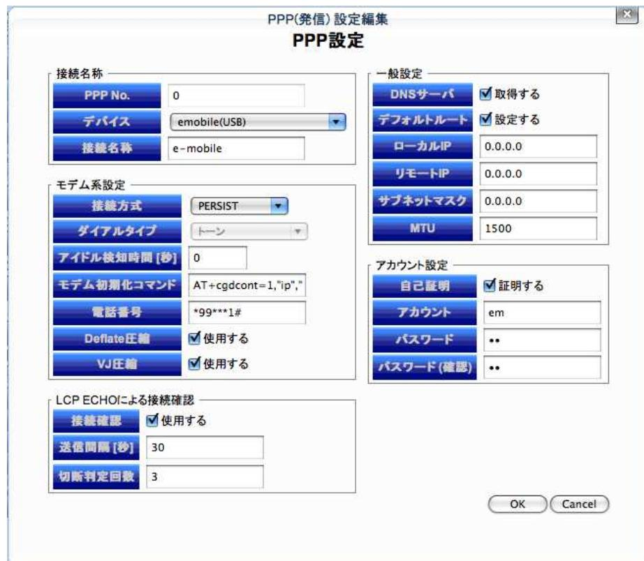
「デバイス」には「emobile(USB)」を選択します。「接続方式」を「通常」にし、PPPインターフェースをデフォルトルートとして設定します。「アカウント設定」は、自動設定されます。OK を押すと、接続設定が追加されます。
