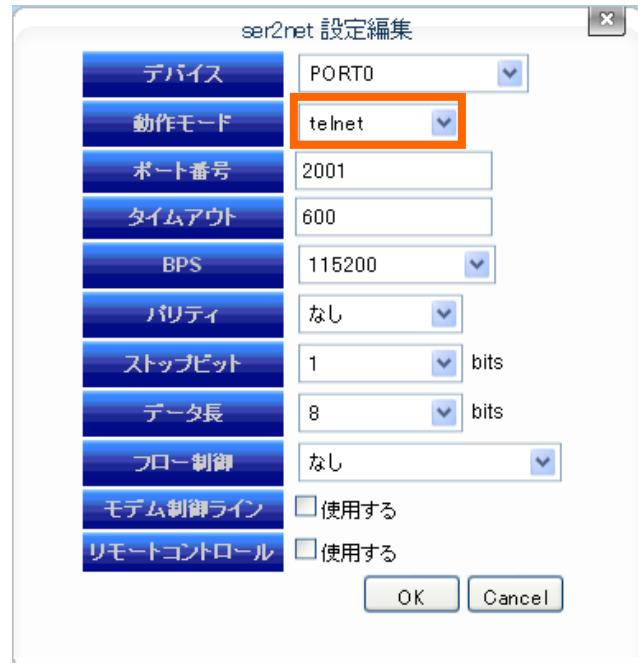
「OK」を押すと、ポート設定を登録します。次に、「サービス設定」において、「サービス」を「使用する」にチェックし、「制御ポート」を「使用する」にチェックします。制御ポート番号に 2000 を入力します。最後に「設定」ボタンを押すと、ser2net デーモンが起動します。
