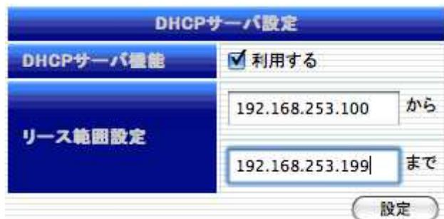
「DHCP サーバ設定」では、以下の項目の入力が完了した後、「設定」ボタンを押下して変更内容を **MA-E2xx** に反映させます。
