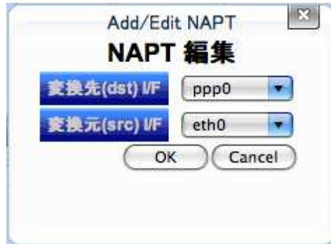
通常、「変換先(dst) I/F」にインターネット側(WAN)を指定し、「変換元(src) I/F」にローカル側の I/F を指定します。
