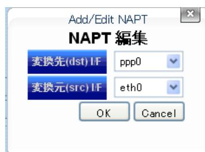
NAPT 編集の画面が開きますので、「変換先 I/F」に「ppp0」、「変換元 I/F」に「eth0」を選択し、「OK」ボタンをクリックします。また、同様に「変換先 I/F」に「ppp50」、「変換元 I/F」に「eth0」を選択し、「OK」ボタンをクリックします。
