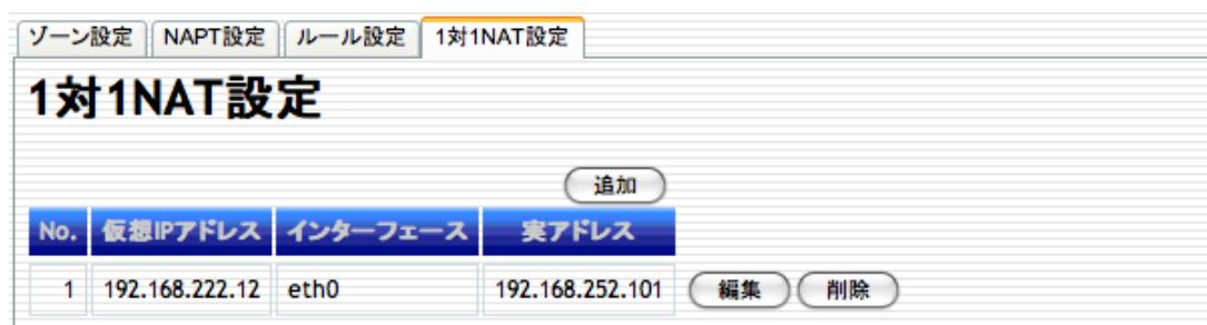
各行右端の「編集」ボタンを押下すると、パラメータの編集が行えます。「削除」ボタンを押すと、当該行の設定が削除されます
