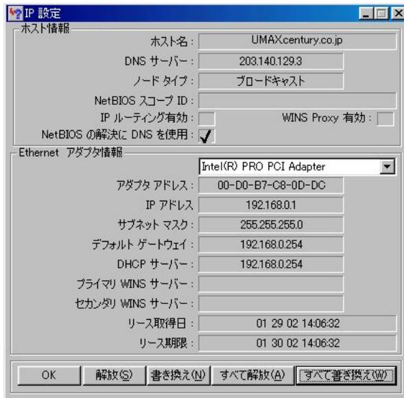
**4** 「IP設定」画面で「全て開放」をクリックすると、現在のIP設定がクリアされます。引き続き「すべて書き換え」をクリックすると、IP設定を再取得します。
