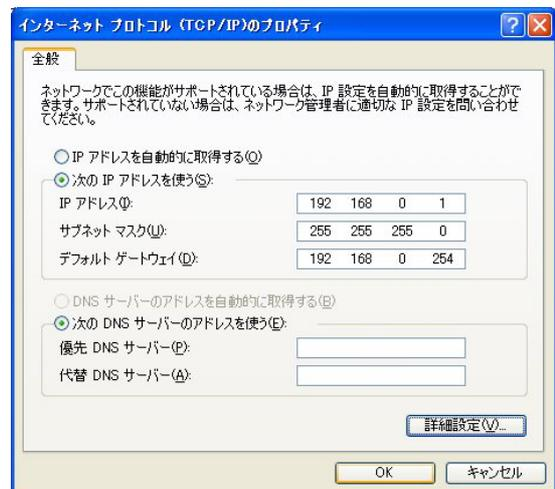
**3** 「ローカルエリア接続のプロパティ」画面が開いたら、「インターネットプロトコル(TCP/IP)」を選択して「プロパティ」ボタンをクリックします。
