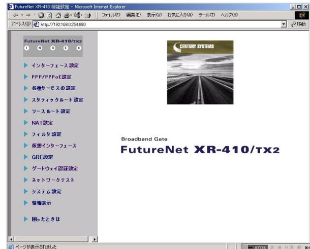
工場出荷時の設定では Ether0 ポート以外のインターフェースではすべてステートフルパケットインスペクションが有効になっています。そのため Ether0 ポート以外のインターフェースからは設定画面にアクセスできません。
