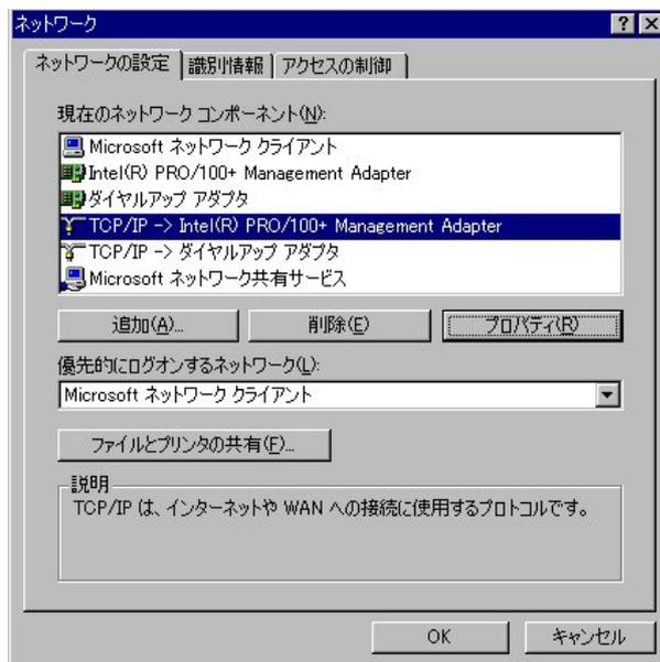
**2** 「TCP/IP のプロパティ」が開いたら、「IP アドレス」タブをクリックして IP 設定をおこないます。「IP アドレスを指定」にチェックを入れて、IP アドレスに「192.168.0.1」、サブネットマスクに「255.255.255.0」と入力します。
