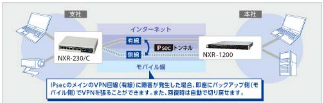
【図2: モバイルデータ通信を利用したVPN構築例】
