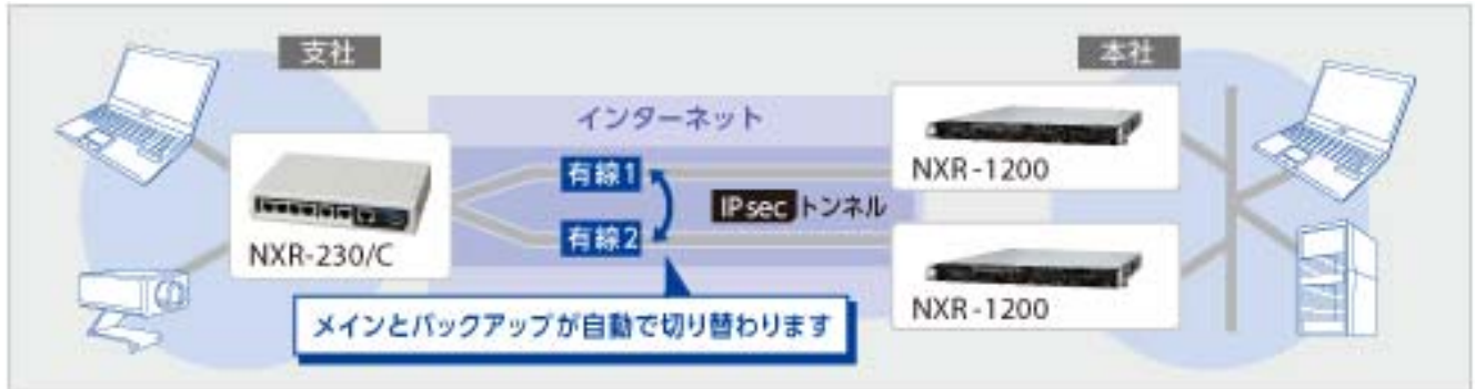
【図1: WAN側を有線で冗長化したVPN構築例】
