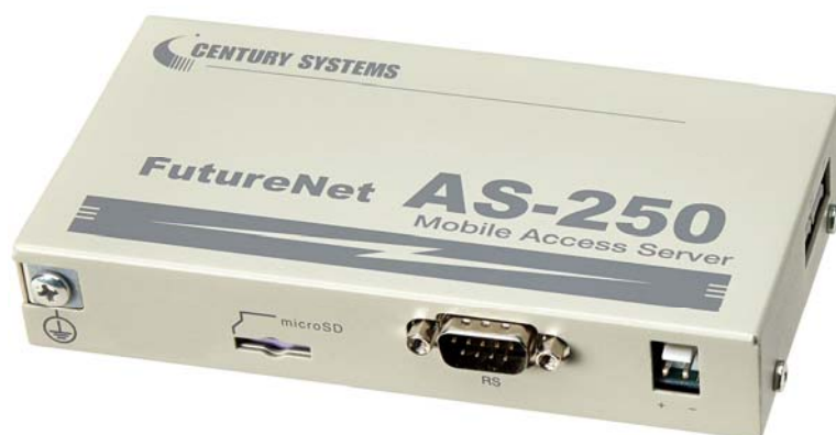
【FutureNet AS-250/X : KDDI CDMA 1X 対応通信モジュール内蔵モデル】
