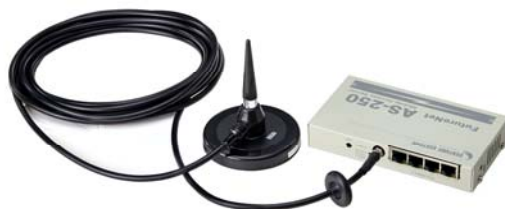
【FutureNet AS-250/X：アンテナ接続時のイメージ(背面側)】
