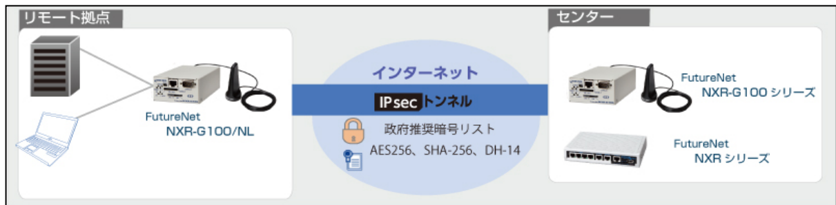
【図 1: モバイルデータ通信、FutureNet NXR シリーズを用いた VPN 構築例】
