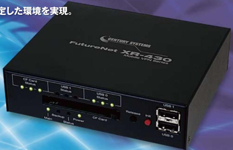
FutureNet XR-430は複数の3.5Gデータ通信端末に対応しており、メイン/バックアップ等で2つのモバイル接続を利用できます。弊社が提供を予定しているダイナミックDNSサービス(WarpLink DDNS)を利用すればモバイル接続を利用したインターネット経由でのリモートアクセスを容易に実現できます。さらに、有線のブロードバンド接続との組み合わせも可能なため、幅広いネットワーク構成が実現できます。モバイル接続を他の通信事業者のモバイル接続でバックアップしたり、有線のインターネット接続をモバイル接続でバックアップするといった使い方が可能です。拠点の状況に応じて有線接続とモバイル接続を柔軟に組み合わせ、低コストで安定したネットワークを実現できます。
