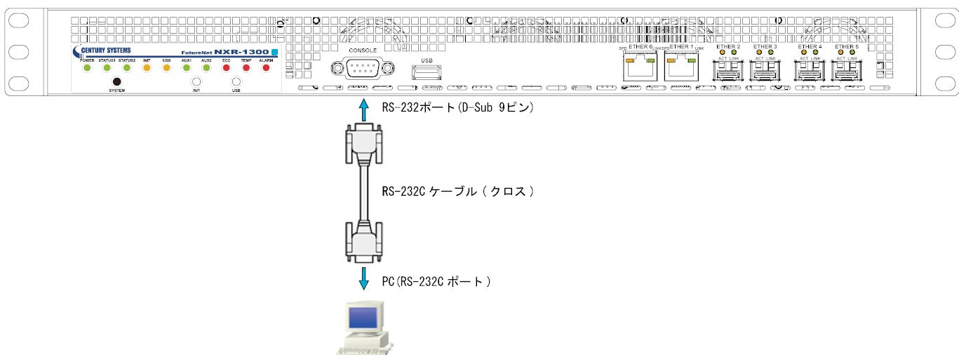
全ての接続が完了しましたら、本装置に電源を投入してください。本体前面の「Power LED」が点灯します。
