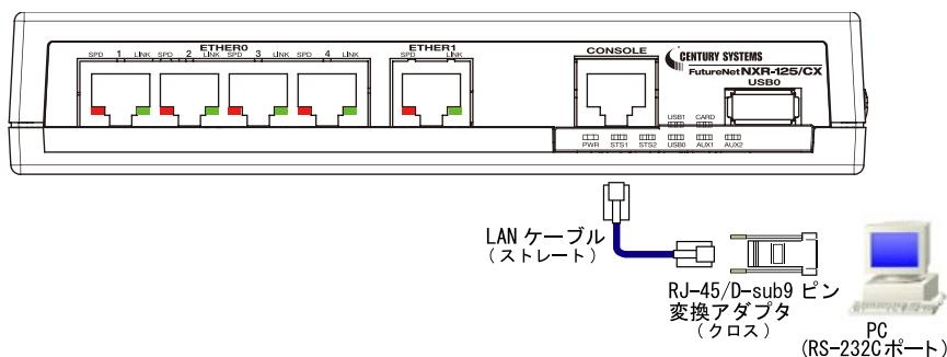
3. 全ての接続が完了しましたら、本装置に電源を投入してください。本体前面の「PWR LED」が点灯します。
