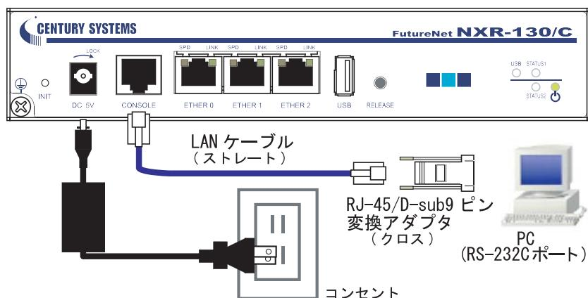
3. 全ての接続が完了しましたら、本装置に電源を投入してください。本体前面の「POWER LED」が点灯します。
