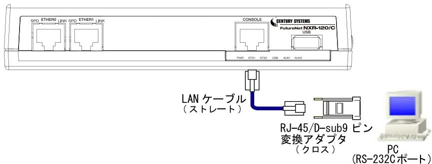
3. 全ての接続が完了しましたら、本装置に電源を投入してください。本体前面の「PWR LED」が点灯します。
