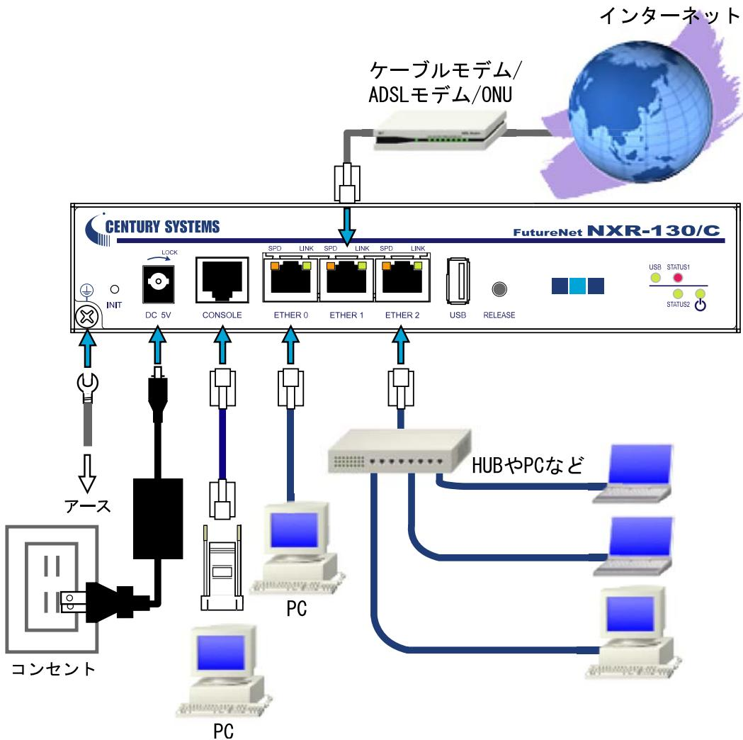
1 本装置とxDSLモデム/ケーブルモデム/ONUやPC・HUBなど、接続する全ての機器の電源が“OFF”になっていることを確認してください。
