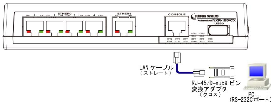
3. 全ての接続が完了したら、本装置に電源を投入してください。本体前面の「PWR LED」が点灯します。
