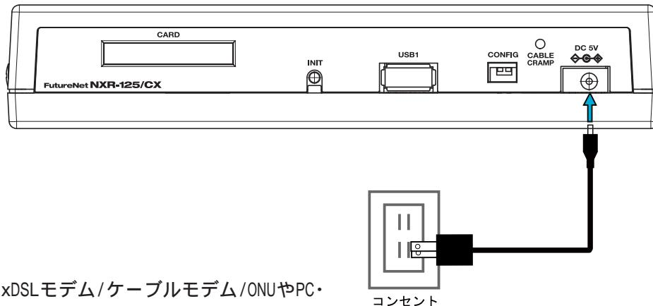
1 本装置とxDSLモデム/ケーブルモデム/ONUやPC・HUBなど、接続する全ての機器の電源が“OFF”になっていることを確認してください。
