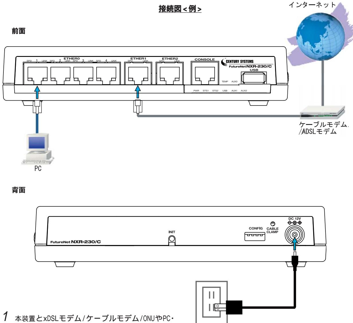
1 本装置とxDSLモデム/ケーブルモデム/ONUやPC・HUBなど、接続する全ての機器の電源が“OFF”になっていることを確認してください。
