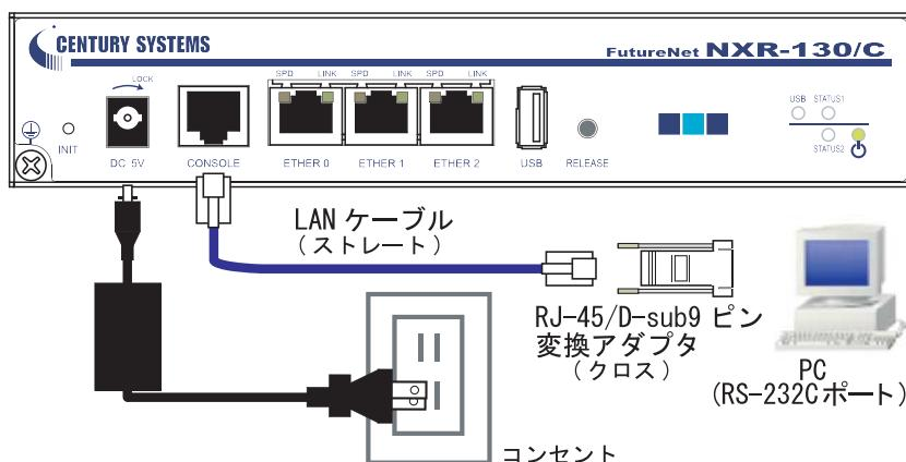
3. 全ての接続が完了しましたら、本装置に電源を投入してください。本体前面の「POWER LED」が点灯します。
