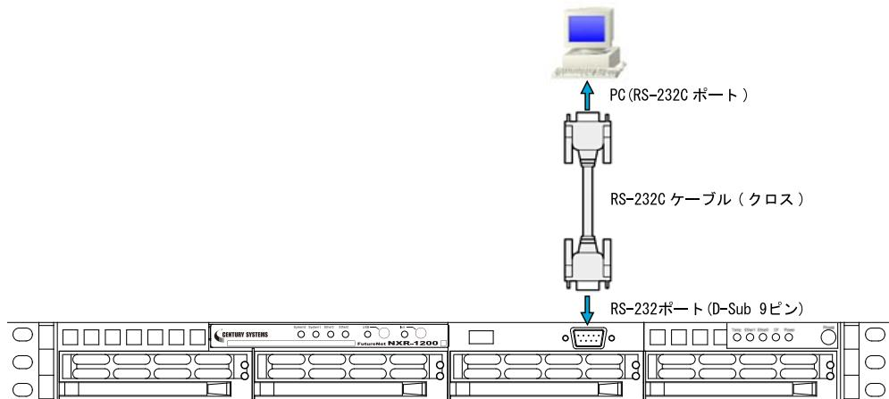
3. 全ての接続が完了しましたら、本装置に電源を投入してください。本体前面の「Power LED」が点灯します。
