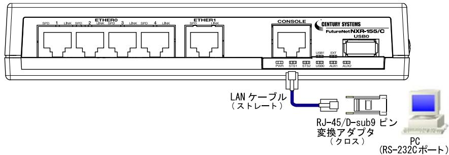
3. 全ての接続が完了したら、本装置に電源を投入してください。本体前面の「POWER LED」が点灯します。
