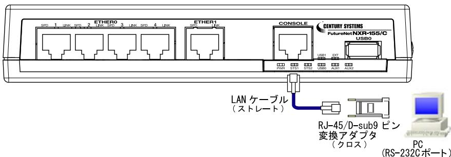
3. 全ての接続が完了しましたら、本装置に電源を投入してください。本体前面の「POWER LED」が点灯します。
