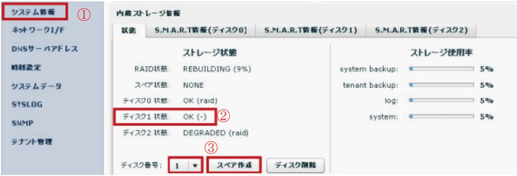
④ HDD 構成が raid(2 台)+spare(1 台) になっていることを確認します。
