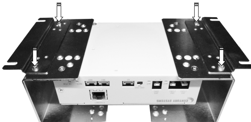
壁設置用金具取り付け
