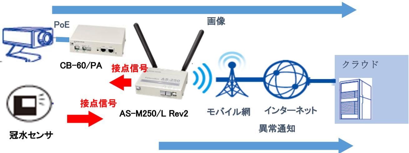
冠水センサで冠水を検知すると接点信号を出力し、信号を受け取った AS-M250/L Rev2 が接点信号を出力して CB-60/PA 経由でカメラを起動させて画像を送信、AS-M250/L Rev2 もクラウドに異常を通知。
