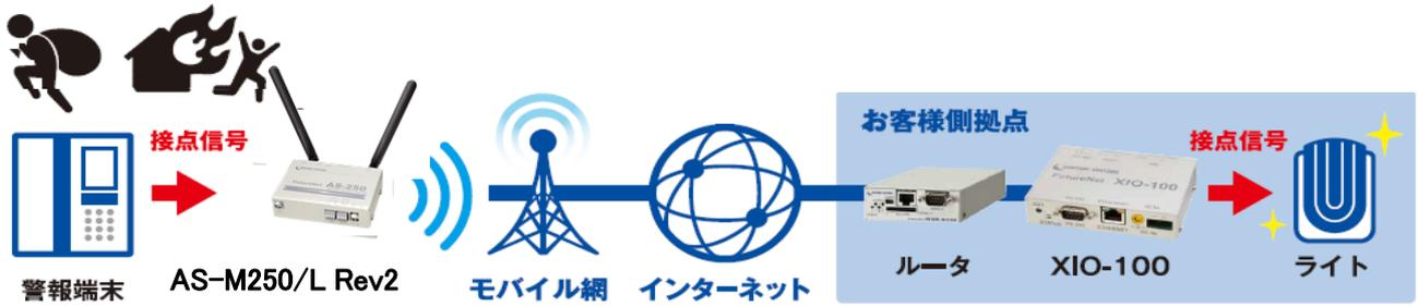
警報端末の異常を接点信号で出力し、信号を受け取った AS-M250/L Rev2 が MODBUS/TCP を利用して、お客様側拠点にある XIO-100 が接点信号を出力してライトを点灯させて、お客様に異常を通知。
