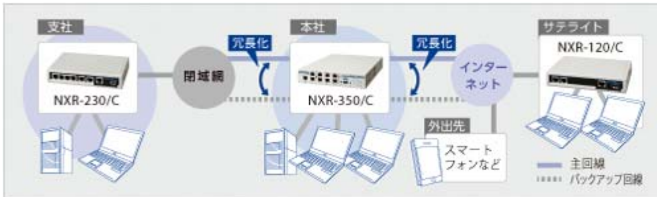
【図 1: NXR-350/C の WAN 側を冗長化した VPN 構築例】
