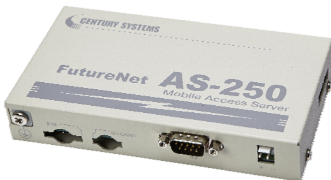
FutureNet AS-250/F-SC : FOMA モバイル網対応通信モジュール内蔵モデル
